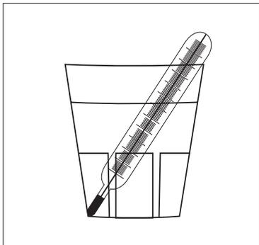
температуру продуктов, хранящихся в холодильнике, установите ручку терморегулятора в среднее положение, поставьте стакан с водой в центр камеры и опустите в него термометр с точностью градуировки  $\pm 1$  °C. Если через 6 часов показание термометра соответствует показанию дисплея, холодильник работает нормально. Измерения необходимо проводить в стационарном режиме работы (без изменения нагрузки).
